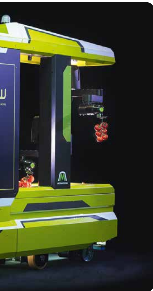
Le robot de récolte de tomates GRoW doit remplacer le personnel dans les serres à l'avenir. RIDDER
