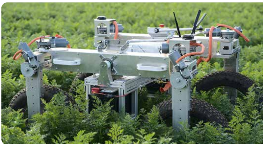
Le robot autonome Catterra élimine les mauvaises herbes au laser. Der autonome Roboter von Catterra bekämpft das Unkraut mit einem Laser. CATERRA
